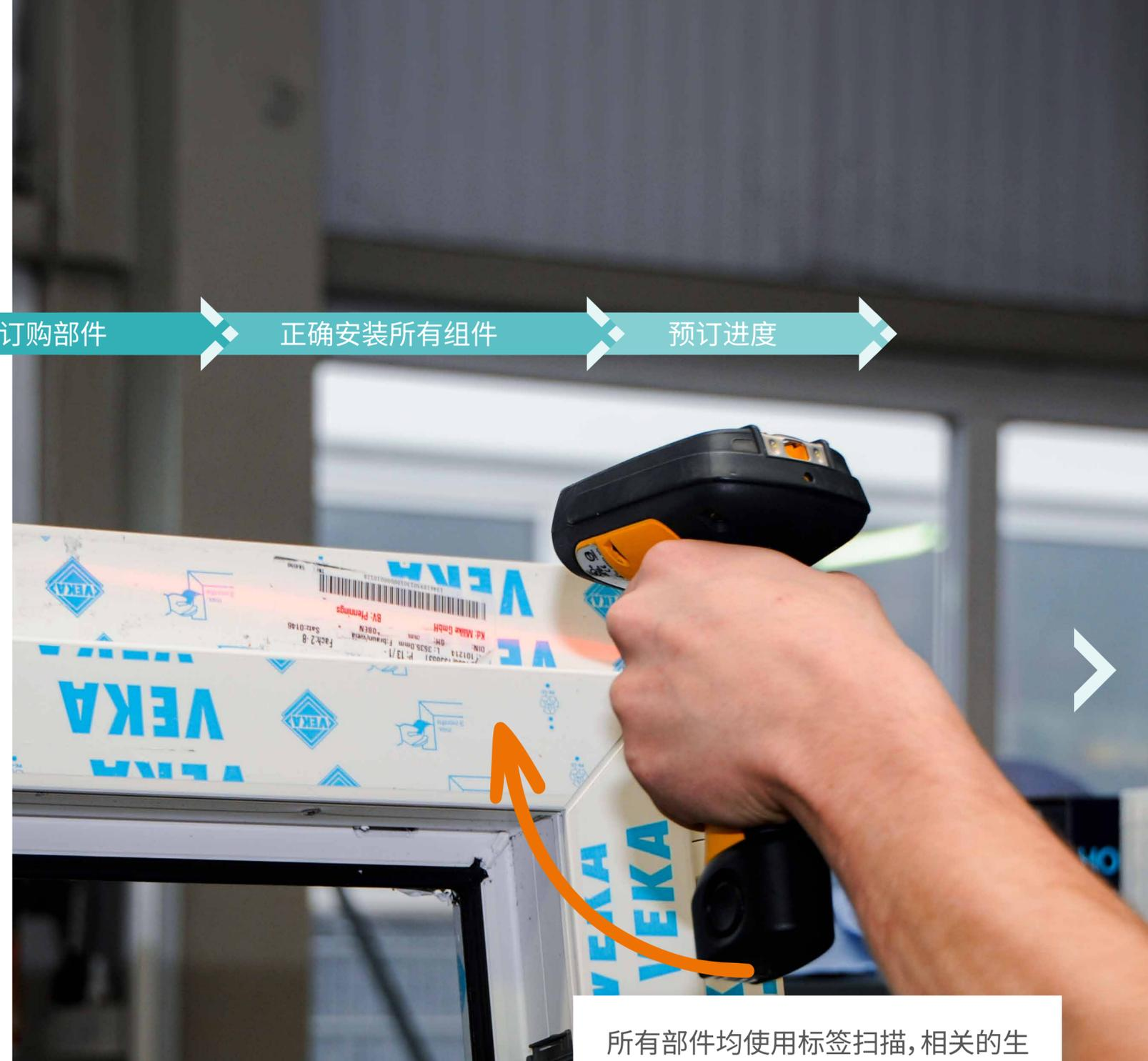
所有部件均使用标签扫描, 相关的生产信息直接显示在 **Klaes e-prod** 中。
